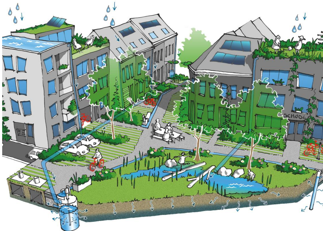
Schematisch overzicht van private én publieke klimaatadaptieve maatregelen in een klimaatstraat.
