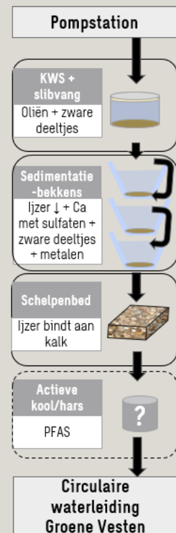
Figuur 5: De zuiveringscascade
